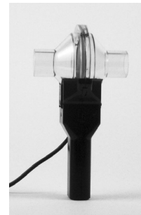
(e) Drücken Sie fest auf dem Durchflusskopf, bis er sicher am Griff befestigt ist. Drücken Sie die Verriegelungen nach innen, um den Strömungskopf einrasten zu lassen.
